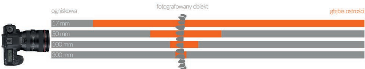
Ryc. 5 Wpływ ogniskowej obiektywu na głębię ostrości. Diagram ma charakter orientacyjny
